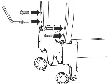
4. Setzen Sie den gekrümmten Auslegerabschnitt in den Auslegerschlitten ein. Befestigen Sie die Baugruppe, indem die beiden 6-mm-Senkschrauben wie unten gezeigt in das mit dem Befestigungs-Kit gelieferte blaue Abdeckblech eingesetzt und festgezogen werden.
