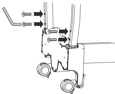
**4.** Inserte la sección curva del larguero en el chasis. Asegure el ensamblado al insertar los dos tornillos de cabeza fresada de 6 mm en la placa protectora azul incluida en el kit de sujetadores, como se muestra abajo, y apriete firmemente.
