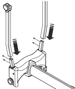
3. Serrez les vis de 6 mm se trouvant de chaque côté du châssis à l'aide de la clé hexagonale fournie.
