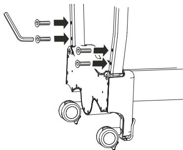
4. Introduisez la partie courbée de la flèche dans le support de celle-ci. Fixez l'ensemble en insérant les deux vis à têtes fraîsées plates de 6 mm dans la plaque de couverture bleue fournie avec le kit de fixation, comme indiqué ci-dessous, et serrez fermement.
