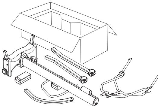
2. Adaptez les pieds au châssis à l'aide de deux vis à têtes fraîsées plates de 6 mm par pied, comme fourni.
