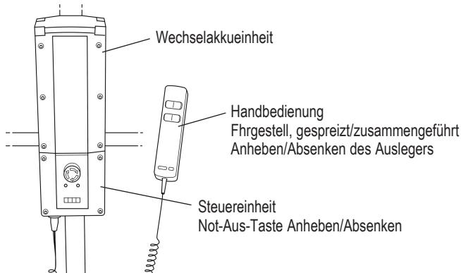
Wenn die Akkueinheit aufgeladen werden muss, wird sie vom Lifter entfernt und an eine externe Ladeeinheit angeschlossen.
