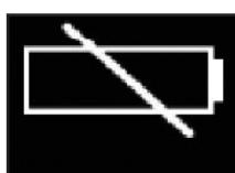
Le symbole de la batterie vide indique que la batterie est complètement déchargée et doit être mise en charge immédiatement.
